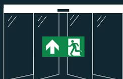
Le porte con funzione di sfondamento, consistono in porte ad una o più ante mobili che operano normalmente ma in caso di emergenza, ante mobili e fisse possono essere aperte a battente tramite una spinta manuale sulle stesse verso l'esterno, le ante si posizionano ai lati in autonomia per garantire un'elevata area di evacuazione in caso di emergenza.
