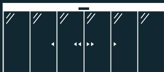
**Le porte telescopiche ad apertura centrale**, consistono in 4 ante mobili che si muovono 2 a 2 in senso opposto con un movimento elegante e sincronizzato, lasciando un ampio passaggio libero nella zona centrale. Particolarmente indicato per necessità di ampie aperture.
