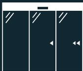
**Le porte telescopiche ad apertura laterale**, consistono in 2 o più ante mobili che si aprono lateralmente con un movimento elegante e sincronizzato, lasciando un ampio passaggio libero anche dove ci sono limitazioni di spazio.
